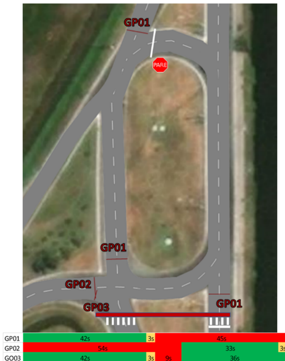
Figura 7 - Configuração dos grupos de semáforos e indicação de sinalização para travessia de ciclistas e pedestres.
