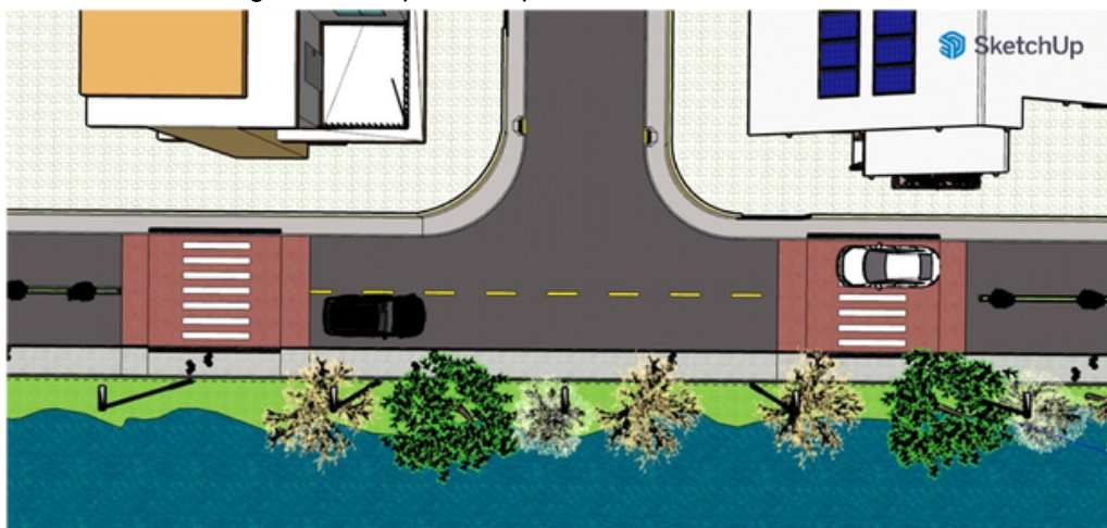
Figura 5 - Proposta de plataformas e canteiro central
