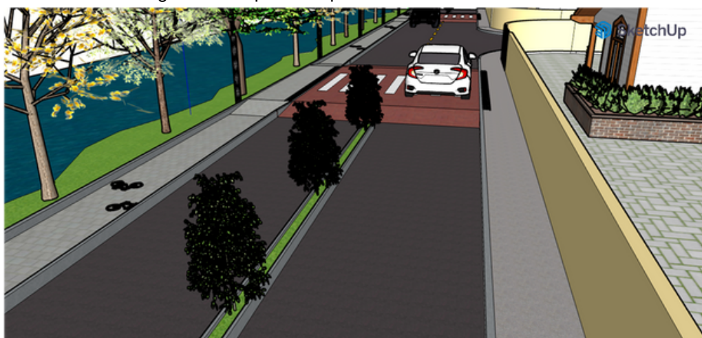
Figura 4 - Proposta de plataformas e canteiro central
